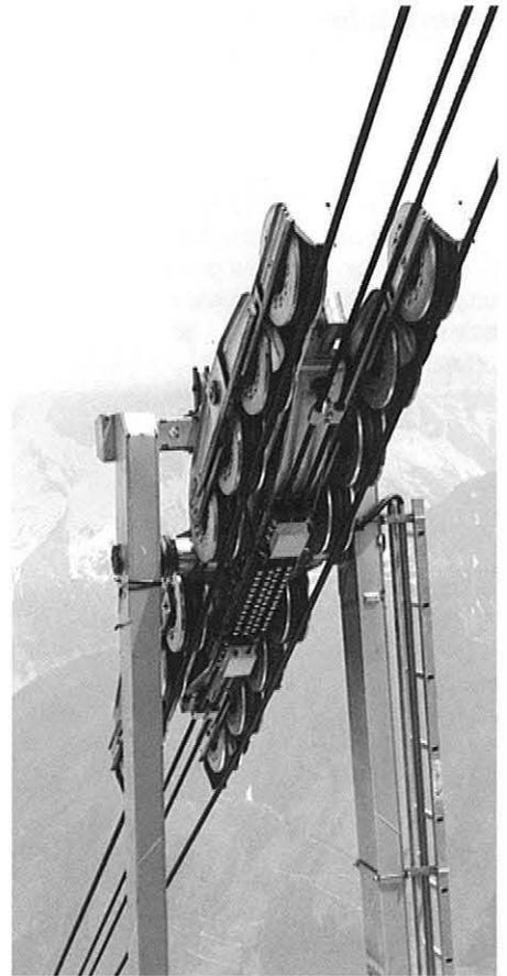
*Das 16-rollige Laufwerk ist ohne Tragseilbremse ausgeführt. Die endlos gespleißten Zugseile sind über tellerfederbeaufschlagte Klemmplatten mit dem Laufwerk verbunden. Vor den Zugseilklemmen sind Schwingungsdämpfer angeordnet.*
