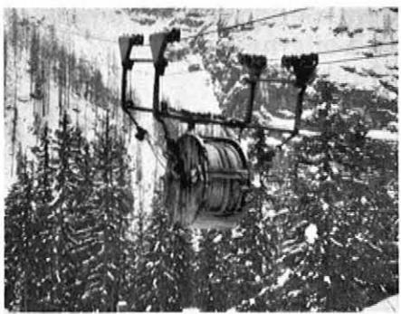
Abb./Fig. 10: Güterseilbahn Schönbergalpe-Krippenstein beim Schwerlasttransport. / Schönbergalpe-Krippenstein material ropeway in operation conveying a heavy load. / Téléphérique à matériaux de Schönbergalpe-Krippenstein pour le transport de charges lourdes.
