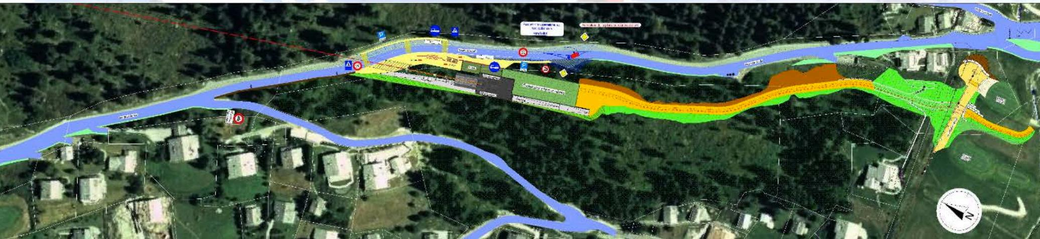
**Une nouvelle piste reliera le Carrefour à la nouvelle gare, avec un tunnel sous le téléski du Rouge dont l'arrivée sera déplacée de 7m sur la droite. La piste passera en tranchée couverte sous la pelouse de deux chalets privés en accord avec les propriétaires de ces derniers.**
