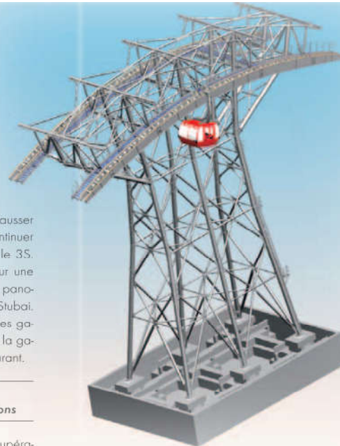
Cuve béton avec des fondations ajustables hydrauliquement dans toutes les directions. Installée dans la zone de pergélisol pour le pylône III (photo) et pour la gare amont.
