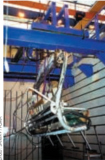
Essais de fatigue d'un siège DOUDOUK en laboratoire.
