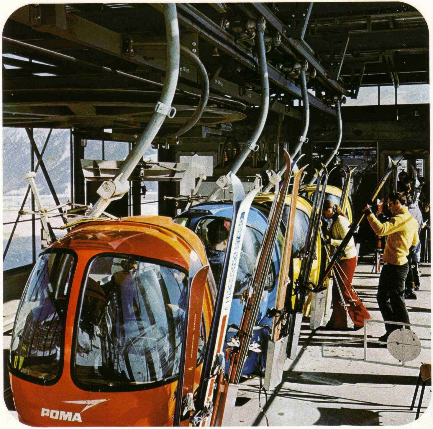
Sur les voies de garage, les sorties et rentrées de cabines se font automatiquement par la manœuvre d'aiguillages et une circulation par gravité sur des rails.
