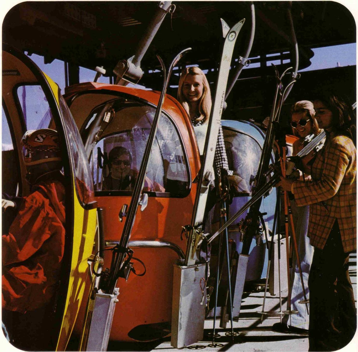
La cabine 4 places est composée de deux demi-coquilles articulées sur une charnière. L'absence de porte permet l'accès en position debout, ce qui facilite les montées et descentes des voyageurs. A l'intérieur, ceux-ci sont assis face à face.
